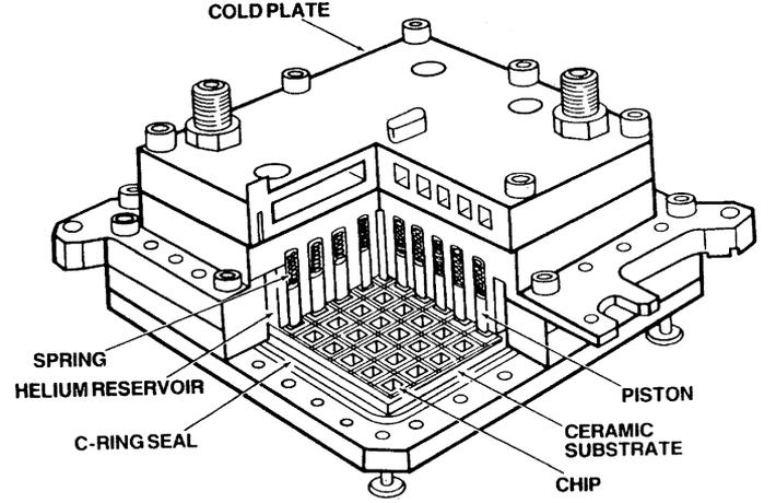
Fig. 11. IBM thermal conduction module (TCM).
